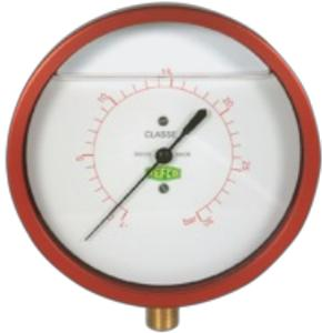
Manómetro de fuelle para altas exigencias en una robusta carcasa de aluminio con escalas de temperatura de evaporación. Los manómetros de fuelle son extremadamente precisos y extremadamente seguros contra la sobrepresión. Debido al llenado de aceite, el manómetro ha reducido la vibración de la aguja para una lectura más precisa. Esto también da como resultado una vida útil significativamente más larga debido al efecto de amortiguación y lubricación.
