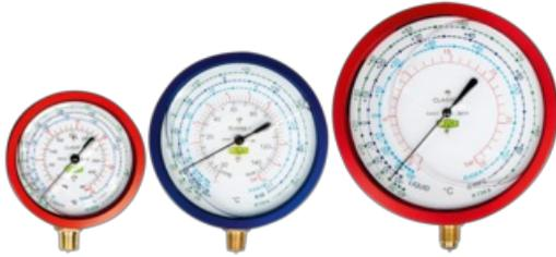
Manómetro de fuelle para altas exigencias en una robusta carcasa de aluminio con escalas de temperatura de evaporación. Los manómetros de fuelle son extremadamente precisos y extremadamente seguros contra la sobrepresión. Debido al llenado de aceite, el manómetro ha reducido la vibración de la aguja para una lectura más precisa. Esto también da como resultado una vida útil significativamente más larga debido al efecto de amortiguación y lubricación.
